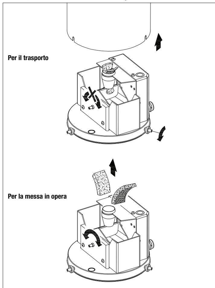
Fig. 6 – Bloccaggio e sbloccaggio della vaschetta basculante
