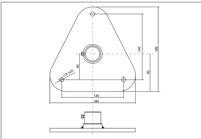
**Fig. 9 – Base per fissaggio a pavimento (HD2013.78)**
