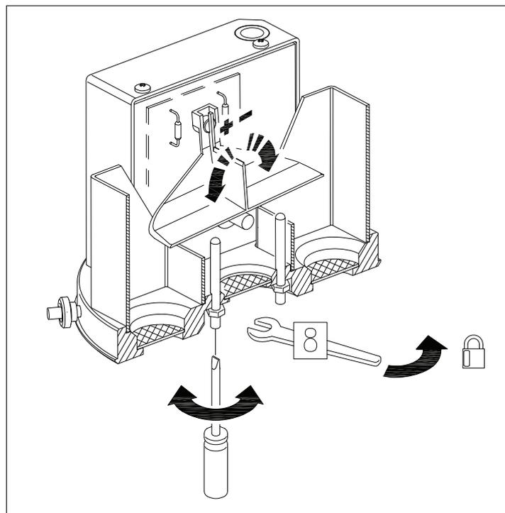
Fig. 7 – Regolazione della vaschetta basculante
