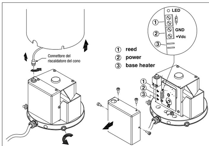
Fig. 2 – Connessioni uscita a contatto e riscaldamento
