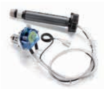
P36090B Pompa peristaltica aggiuntiva per il dosaggio di un additivo supplementare completa di sensore di livello. La gestione della quantità di detergente erogato dalla pompa e' direttamente gestito dal microprocessore dell'apparecchiatura.
