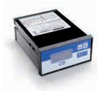
IC6000 Indicatore digitale in grado di monitorare la conducibilità delle acque di scarico. Particolarmente utile quando viene utilizzata acqua demineralizzata per i risciacqui finali. Se la qualità dell'acqua allo scarico presenta elevati valori di conducibilità si suggerisce quindi di procedere ad ulteriori risciacqui. Range di misura compreso fra 0 e 1000 µs/cm. lettura dei valori visualizzata su display lcd retroilluminato. Indicazioni visive per rilevazioni di parametri fuori scala. Installato ad incasso nel frontalino della macchina.
