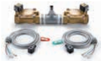
WD-VDS Valvola doppio scarico che permette di separare e canalizzare l'acqua di scarico inquinata dei primi lavaggi dall'acqua dei risciacqui finali. Questo dispositivo per la separazione degli scarichi è composto da valvole da 1 e 1/2" con membrana in viton e apertura valvola comandata tramite il microprocessore della macchina.
