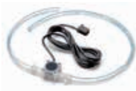
WD-FLUX FLUSSOMETRO PER POMPE PERISTALTICHE Permette il controllo della quantità di additivo dosato dalle pompe peristaltiche. Installato direttamente in macchina su ogni singolo condotto di introduzione detergente in vasca. Segnala eventuali anomalie di dosaggio o l'esaurimento dei prodotti direttamente mediante un avviso riportato a display.
