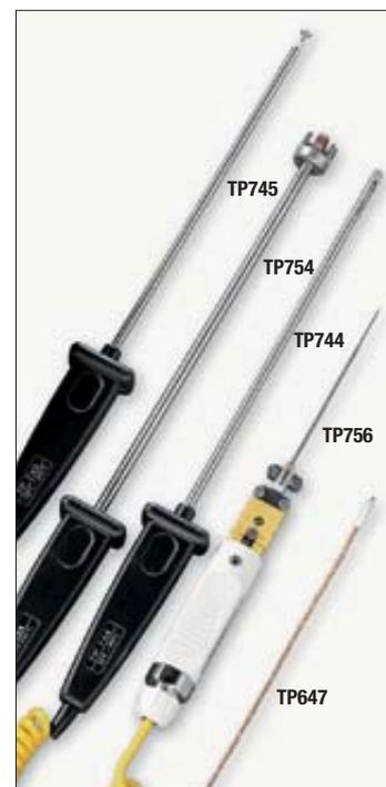
Misura di pressione, velocità dell'aria e portata calcolate con il sensore interno, temperatura con termocoppia K
