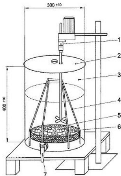
La porzione di prova è dove andrà posizionato il campione, questi aggregati devono essere sottoposti alla prova rispettando la granulometria nella quale sono generalmente forniti. I granuli maggiori di 32 mm devono essere frantumanti e si deve isolare la frazione 16/32 mm. Questo materiale viene aggiunto al campione in preparazione nella percentuale in cui la frazione maggiore di 32 mm era presente nel campione originale.
