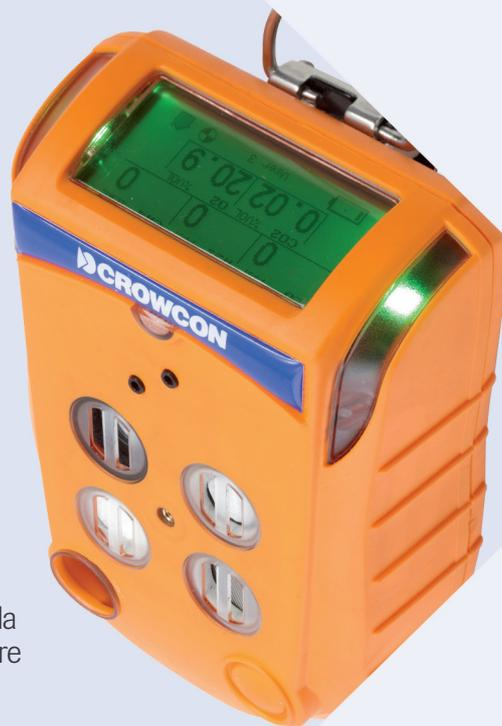
Gas-Pro prevede l'utilizzo di un'ampia gamma di opzioni di sensori, tra cui sensori a infrarossi La gamma per la rilevazione di gas infiammabili e o CO2 con risposta rapida garantita, requisiti di manutenzione molto bassi, lunga durata e funzionamento fail-safe. Inoltre, Gas-Pro è disponibile anche con un sensore PID per la rilevazione di un'ampia gamma di composti organici volatili, ideale per l'industria chimica, specialmente se si lavora con serbatoi contenenti solventi.
